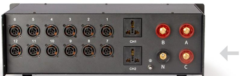
※注意：接入AC380V三相电，注意火线（A.B.C）与零线(N)不可接反；接地线(PE)要良好接地；此时面板指示灯亮起，空气开关打到ON状态；这时接入的灯具应亮起。
